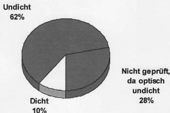
Abb. 9: Ergebnisse der Dichtheitsprüfung an den Schmutzwasser-Revisionschächten im Privatbereich
